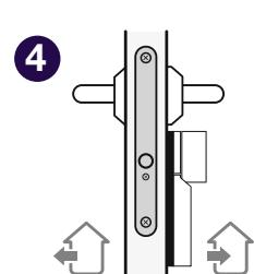
Fixieren Sie den Zylinder mit der Stulpschraube und drehen Sie den Knauf zurück in die Nullstellung.
