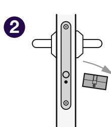
Entfernen Sie den gegenwärtigen Zylinder.
