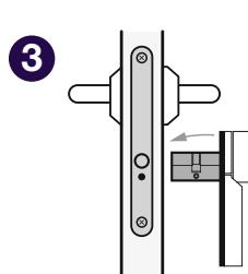
Schieben Sie den Zylinder (einschließlich Grundplatte und Knauf) von der Innenseite der Tür her hinein.
